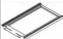
TELAIO PER INSERIMENTO STRUTTURE ESTRAIBILI
